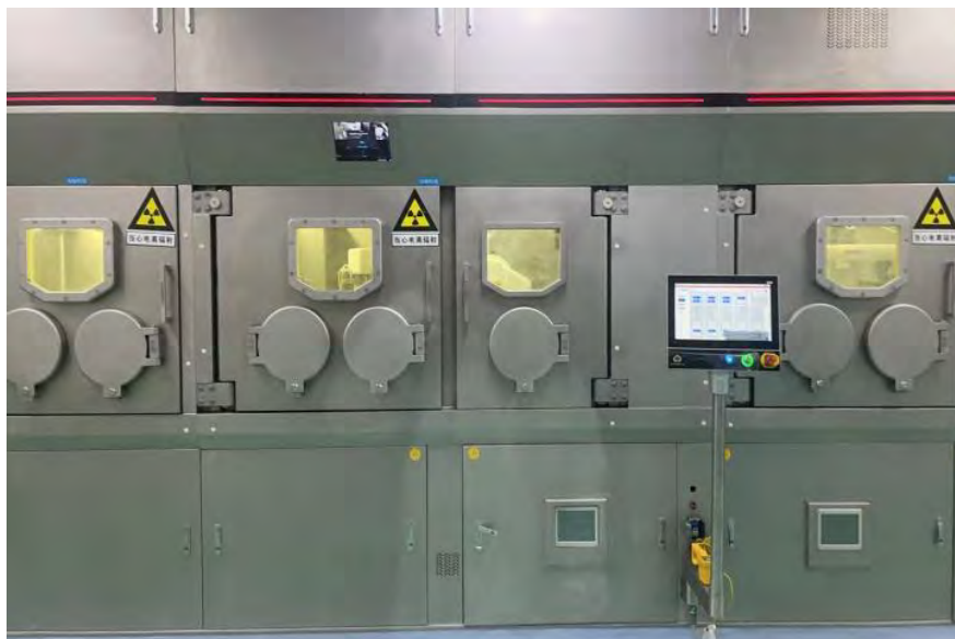
图9-3 拟新增的同类 \alpha 核素防护热室外观图
